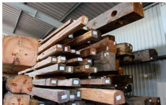
Die Firma Knapp lagert Altholz in verschiedenen Stärken witterungsgeschützt: mit Querschnitten von bis zu 45 cm x 45 cm stammen einige der größten Balken dabei von Weinpressen
